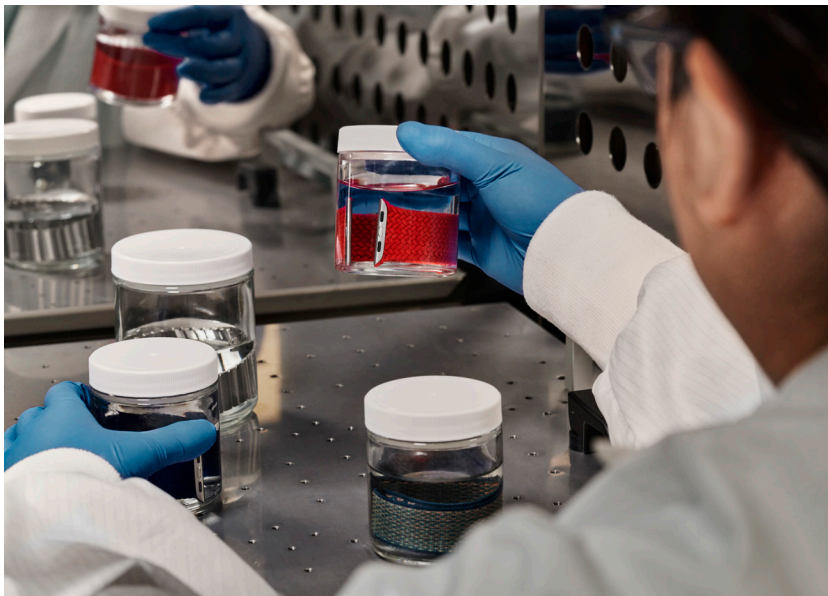
我们使用模拟汗液的液体对产品进行测试, 以评估这些产品的生物相容性。
