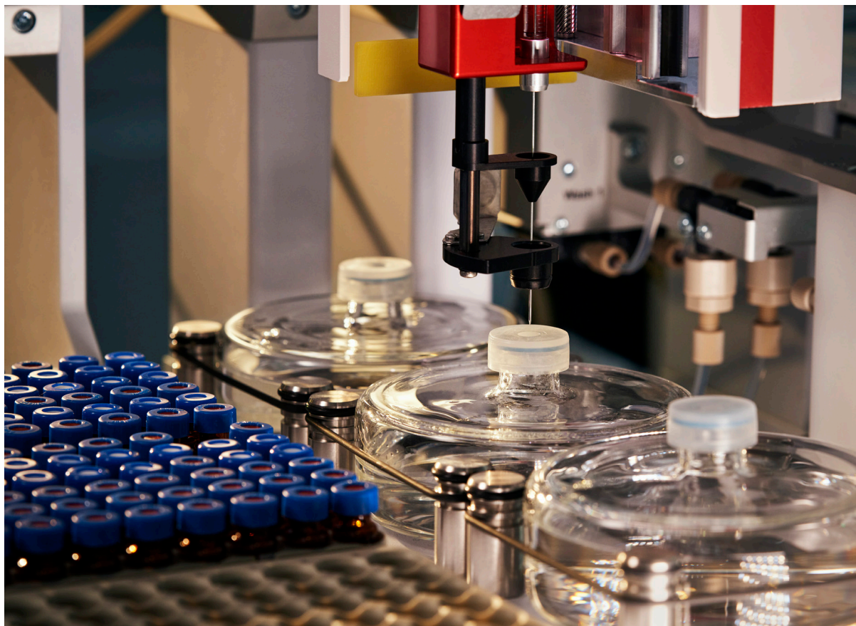
我们借助气相色谱-质谱仪系统等设备，评估材料中《受管制物质规范》限用物质 (包括 VOC) 的含量。
