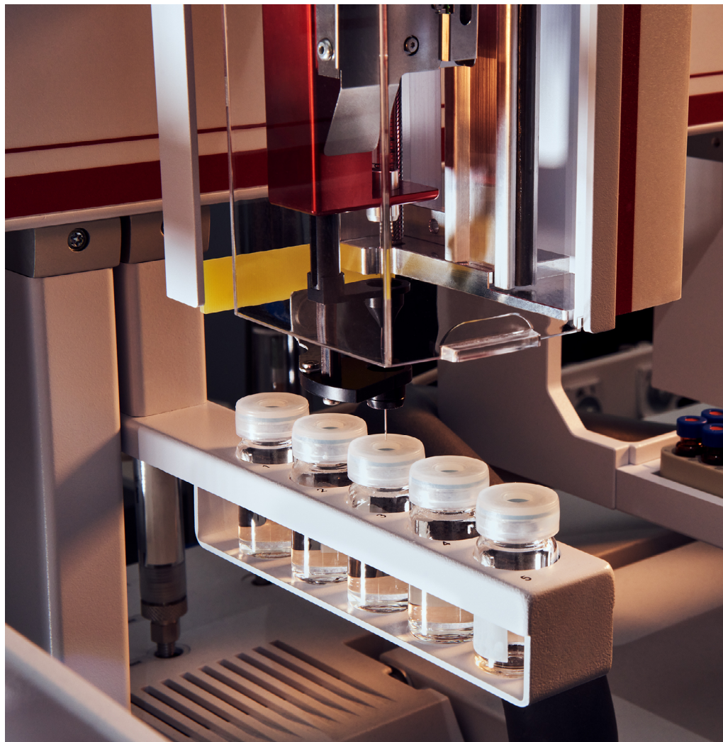
我们借助气相色谱/质谱仪 (GC/MS) 系统等设备, 评估材料中《受管制物质规范》限用物质 (包括 VOC) 的含量。
