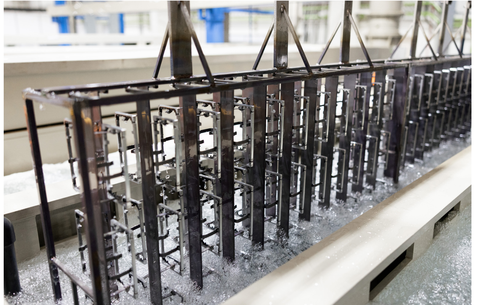
铝金属阳极氧化工艺通常需要消耗大量水资源。2019 年, 我们启动了一个试点项目, 目的是消除危险排放, 提高阳极氧化工艺的用水效率。级联清洗和逆流漂洗工艺可将 75% 至 85% 处理金属表面过程中使用的水保留下来, 如果大规模采用, 每年可以节省数百万加仑淡水。
